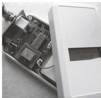
↑写真1/JF11QQ下地さん設計・製作の電界強度計。
