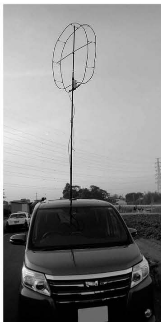
←写真9/JR10AO中島さんが2016年に作った直径1.3m、2回巻きMLA。これで136kHzにチャレンジ。
