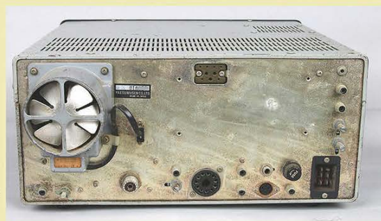
⇒写真17 / 裏目に豊富な端子を備えるのが101シリーズの特徴。冷却ファンは取り外しが容易。
