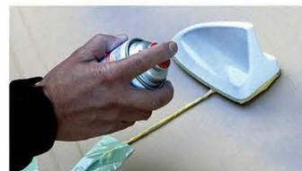
↑ASF-351から20cm程度離れた場所から「ブラサフ」をスプレーする。ムラにならないよう気をつけて塗装することが重要だ。
