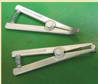
◀あると便利な工具、ヒートクリップ(2個1組で300円)。ピンセットでつまみにくい部品の保持に重宝する。
