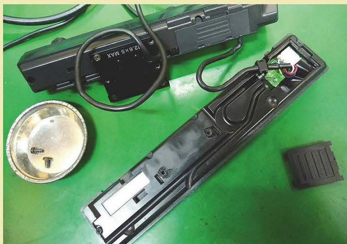
←TM-942のコントローラーは2つに分離する仕組み。ディスプレイ裏側にアクセスするため、まずはユニットを分離。
