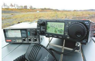
↑アイコムの100W機、IC-706MK2G。移動運用に使用するため50W機へとメーカー改造済。SWR計を通して運用します。
