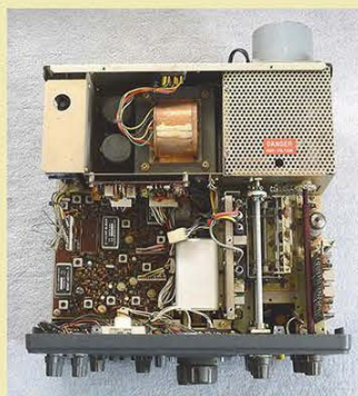
←写真15 / FT-101Zの内部を上から見る。右上のシールドされた部分が終段回路。
