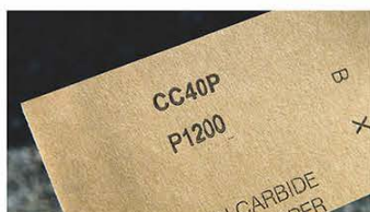
↑「ブラサフ」塗装する前に、耐水サンドペーパーの1200番で、ASF-351ボディ表面の塗装を削り落とす。キメの細かいサンドペーパーだ。
