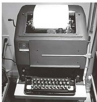
↑メカニカル時代のテレタイプ・マシン。大型で騒音も大きかったが、通信社や商社などニーズが高かった。テレタイプは2点間、テレックスは相手局を選べた。この払い下げ品をアマチュア無線で利用していた。
