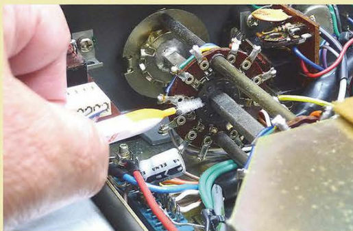
↑写真12 / スイッチは歯間ブラシで接点の汚れを落とし、接点復活剤を吹いた。
