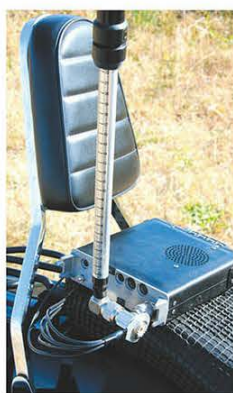
←アンテナは第一電波工業のRHM8B(税抜13,800円)。7~50MHzをカバーする。
