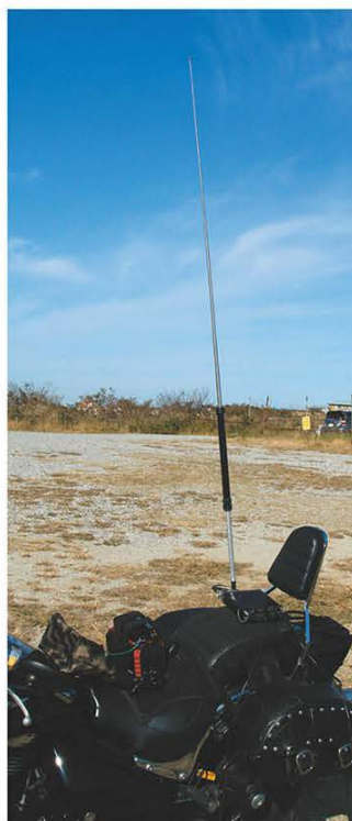
↑RHM8Bを7MHzにセットしたところ。手軽な移動運用には最適なアンテナだ。
