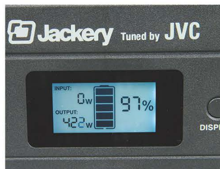
↑本体前面には、充電電池の残容量表示と出力時のW数を表示するディスプレイを装備。画面のON/OFFの切替えスイッチもある。
