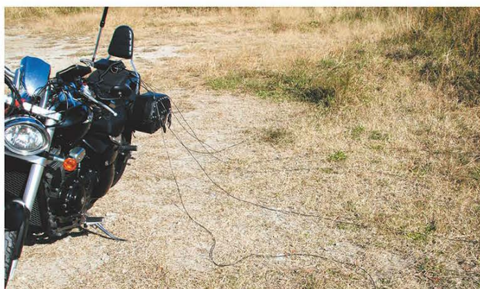
←アンテナは第一電波工業のRHM8B(税抜13,800円)。7~50MHzをカバーする。
