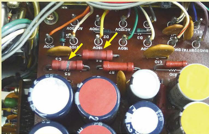
↑写真7 / 高圧整流基板の抵抗が何本か焼けているのを発見(矢印)。電解コンデンサーの不具合で、流れてはいけないところに電流が流れたことがあとになって判明。
