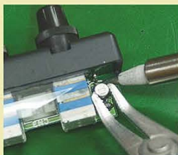
◀あると便利な工具、ヒートクリップ(2個1組で300円)。ピンセットでつまみにくい部品の保持に重宝する。
