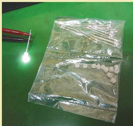
↑ビニール袋内上がLED、下が光拡散キャップ。点灯テスト中。
