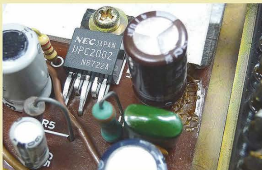
↑写真10 / 液漏れした電解コンデンサを交換した。これが今回の無線機の根本的な故障箇所だった。
