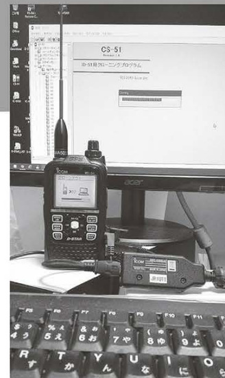
↑ SD カードによるインポート機能のないハンディ機、ID-51 と PC を接続、データを転送中。やってみれば、意外に作業は簡単だ。
