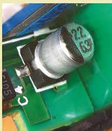
◀操作部内部の基板にあった電解コンデンサー。液漏れの痕跡がある。
