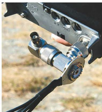
⇒FT-818のアンテナ端子部分。アース用にCQオームで購入したラジアルケーブルセットを活用。
