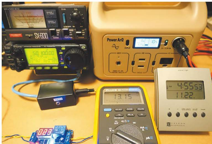
↑ポータブル電源の運用可能時間のテスト画像。IC-706MK2Gと50Wダミーロードの間にパワーメーターを接続。オノフタイマー(左手前の青LEDが点灯しているモノ)で、コネクターBOXを介したPTTを送信1分、受信3分の間隔で操作させてPower ArQの電圧の変化を測定(中央のテスター)。送信パワーは50MHz・FMで20W。右のタイマー時計で時間の計測。実験の結果、半日程度ならSSBを50W運用することが充分可能であることがわかりました。
