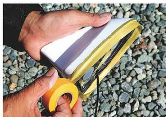
↑塗装しない部分にマスキングテープを貼る。特に塗装する部分と塗装しない部分の境目は、慎重にマスキングテープを貼る。
