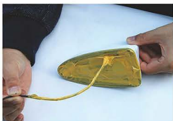
↑ASF-351裏面とケーブル部分は隙間なく完全にマスキングテープを貼る。スプレー塗装なので、飛び散ることも計算に入れてマスキングする。
