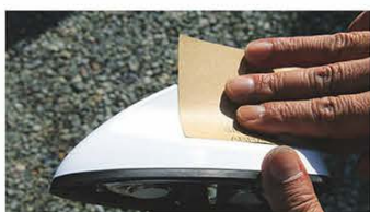
↑耐水サンドペーパーで、削りムラがないようにいねいに塗装を削り落とす。表面がザラっとした感触があればOKだ。削り過ぎに気をつけること。
