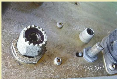
↑写真4 / 長期間使用していなかったと思われる本機。アンテナ端子の腐食も見られる。
