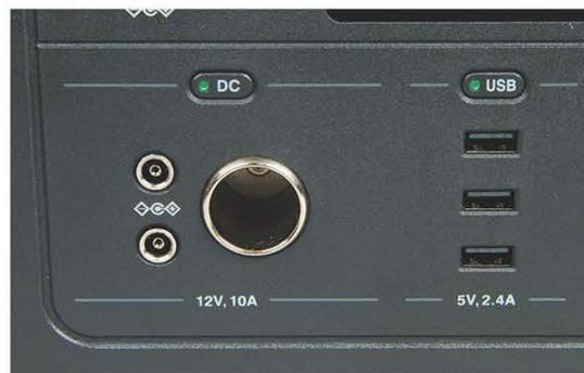
↑DCはシガーソケット出力とDCポートの出力端子を持つ。なお、ACやDC、USBとも使う時はそれぞれの電源ボタンを押して使う。
