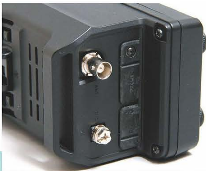
↑本体左側面にアンテナ端子 (BNC)、その下にアース端子を備える。
