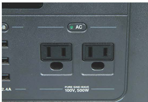
↑本体に「PURE SINE WAVE」と記載されているとおり、AC100Vでは、正弦波を生成するインバーターを搭載。周波数は60Hz固定
