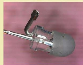
↑リードが膨らんでいる部分の先でカット。拡散キャップも取り付けけた。
