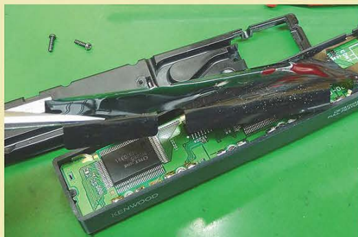
↑ディスプレイのある側のユニットを開ける。絶縁シートをめくると基板が見えてきた。
