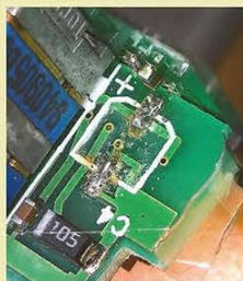
◀22 \mu Fであるべき電解コンデンサーの静電容量の測定。0.04 \mu Fと、完全に容量抜けを起こしていた。
