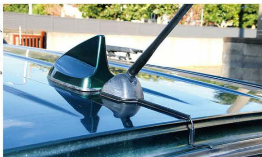
←塗装前のフィン型アンテナ(右)と塗装後のフィン型アンテナ(左)。まるで特注品で購入したような完璧な塗装処理ができた。
