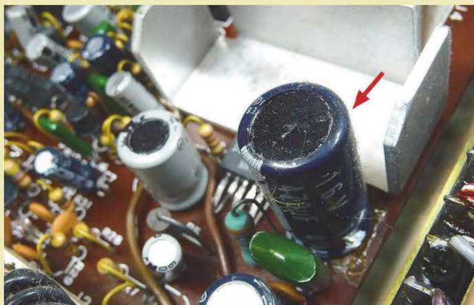
↑写真8 / AFユニット基板の電解コンデンサーが液漏れを起こしていて、アルミケース筒も膨らんでいるように見える(矢印)。
