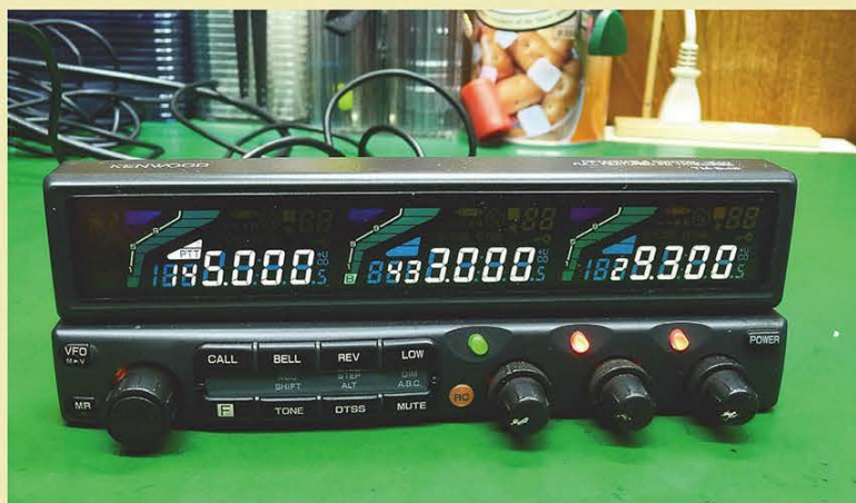
↑LED交換完了し、さっそく点灯。コントラストが向上し見やすくなった。現代風で、30年近く前の無線機という感じがしない。LEDも色の種類があるので、自分の好みの色にするとよいと思う。
