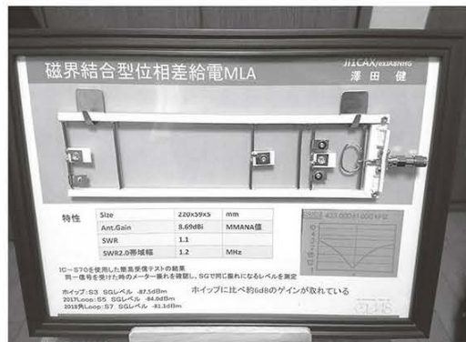
↑写真13/JIICAX澤田さん命名の「430MHz磁界結合型位相差給電MLA」。
