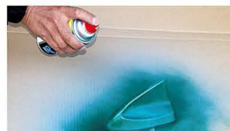
↑カラーペイントスプレーも20cm程度離れた位置からスプレー塗装をする。周囲に飛び散らないよう、またムラにならないよう注意をする。
