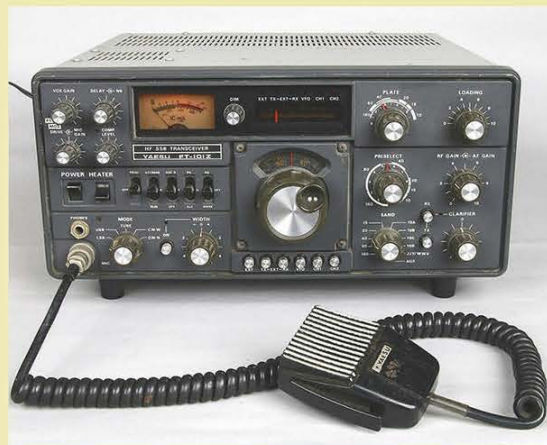
⇒写真16 / 修理が完了したFT-101Z。パワーが60W程度出るようになった。
