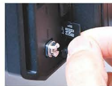
↑microSD カードスロットを備え、各種データ、録音音声データ、ディスプレイのキャプチャー画像データなどを記録できる。
