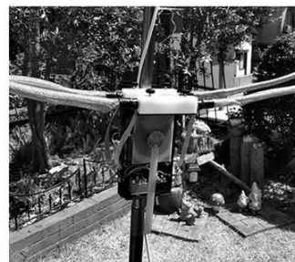
↑写真11/JA9BSL野村さんのビッグスーパー。ループアンテナはガラスファイバーロッドに網線をかぶせた構造。
