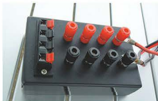
↑電源を分配する配電盤です。夜間には照明、夏なら卓上扇風機など、他の電気器具を動かす時などにも、便利なグッズです。
