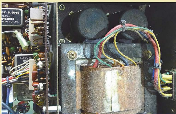
↑写真6 / 電源トランスと高圧コンデンサー周辺は、高電圧で吸い寄せられたホコリがたくさん積もっている。なかなか年季の入った無線機だ。
