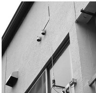
↑常置場所東側ベランダに設置のHF～144MHz帯CA-HVモバイルホイップアンテナ。こんなアンテナでもEスポシーズンになれば59で入感してきます。
