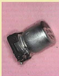
◀取り外した電解コンデンサー、22 \mu F/6.3V。この部品はそれほど顕著ではないが、経年変化で膨らんだり、破裂したりすることもある。
