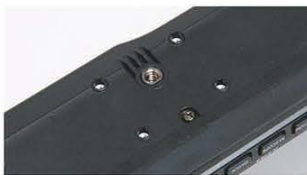
↑本体底部には三脚ネジ穴を備える。オプションで用意されるマルチバッグ LC-192 には、この穴を利用して固定。自作の取り付け台を作る際にも利用できる。
