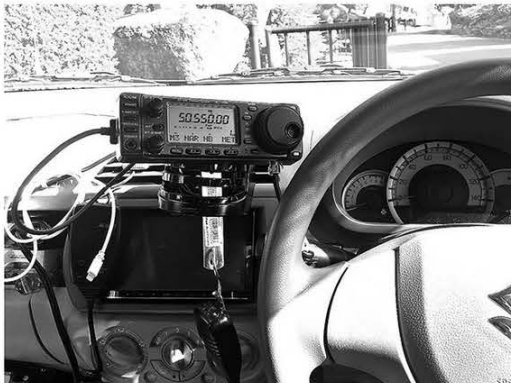
↑JP3UYR 局のモバイルシャックの様子。IC-706 のコントローラーは、ドリンクホルダーを利用して取り付けられている。
