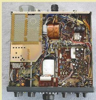
←写真14 / FT-101Zの内部を下から見る。基板の部品が見やすく、メンテしやすい構造だ。
