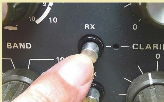
↑写真3 / プッシュボタン不動・固着。こうなると時間をかけて分解・清掃するか（直るとは限らないが）、同機種のジャンク品からパーツを持ってくるしかない。
