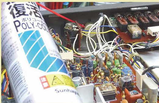
↑写真11 / 修理が完了したら、予防的なメンテナンスを施す。ポリウムには接点復活剤を吹いておいた。
