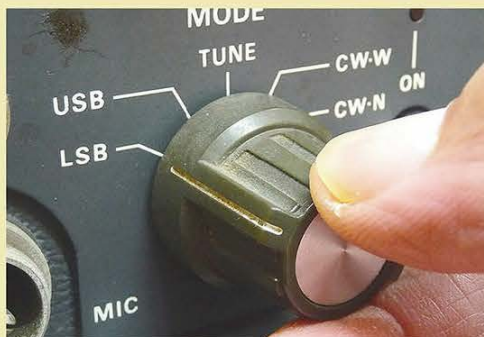
↑写真2 / モード切り替えスイッチの軸にガタを発見。
