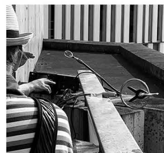
↑写真17/JR10AQ 中島さん製作の144MHz用と430MHz用のMLA。
