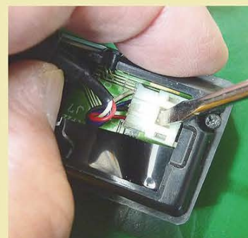
↑2つのユニットをつなぐ接続ケーブルを外す。ドライバーでロックのツメを押し、ていねいに作業する。
