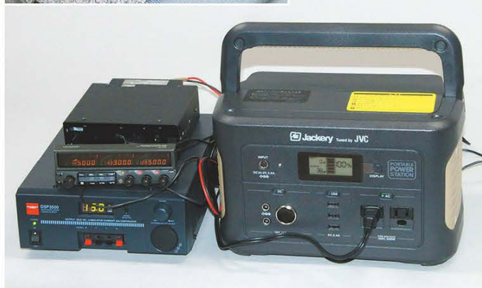
↓アマチュア無線運用では、安定化電源を用意することで、AC100VからDC13.8Vが得られる。
