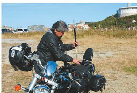
↑RHM8Bは伸縮式(全長0.5~1.78m)。運用周波数に合わせて、エレメントの長さをセットする。
