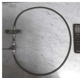
↑図10/JA5KVK/1小川さんがひらめいた「One-Loop MLA」の構造。
