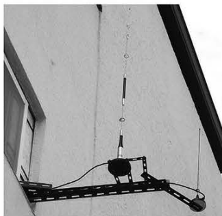
↑常置場所の無線機が設置してある部屋の小窓から出した、430/1200MHzモバイルホイップアンテナ、第一電波工業SG9500Mと、144/430MHzマグネットマウントアンテナ、第一電波工業MR75B。
