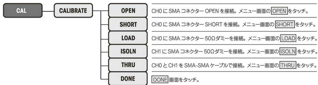
図1/VNAの最初の一步。校正の方法。
