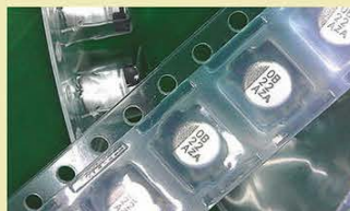
↑新しい部品を購入(22 \mu F耐圧10V)。チップ部品は、このように複数のバックでないと購入できない。
