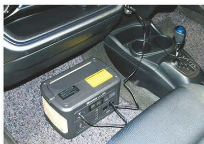
←クルマのシガーアダプターを使って充電した場合、約18時間で満充電に。家庭のACだと半分の約9時間で満充電となる
