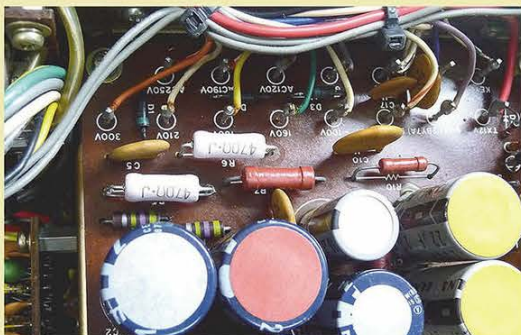
↑写真9 / 焼けて断線した抵抗を交換した。本来流れるはずのない直流の大電流が流れたのが原因だった。
