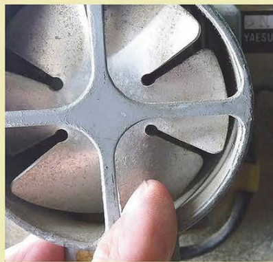
↑写真3 / プッシュボタン不動・固着。こうなると時間をかけて分解・清掃するか（直るとは限らないが）、同機種のジャンク品からパーツを持ってくるしかない。
