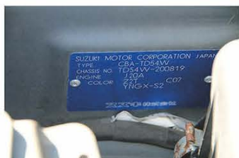
↑エンジンルーム内の左側上部に型式プレートがあった。車両型番、エンジン型番の下にカラーナンバー「Z2T」が明記されていた。
